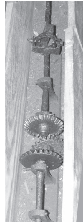
Das Getriebe überträgt den Antrieb vom Uhrwerk zwei Turmetagen tiefer auf die waagerechte Welle zu den Uhrzeigern
